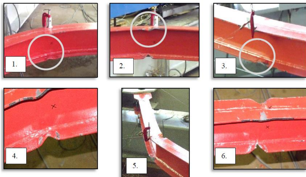
Фиг. 1. Стадии на развитие на пластичните деформации в диагоналите при провеждане на цикличен тест с променлива амплитуда [21]
