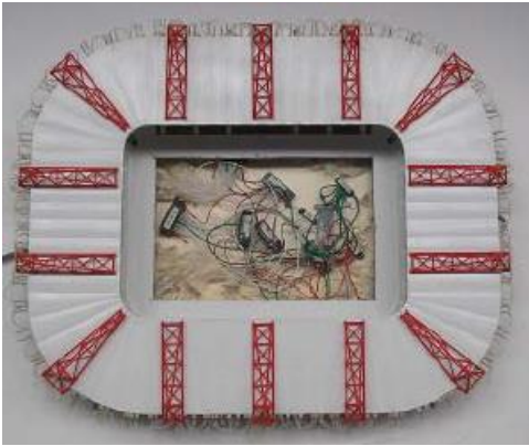
Фиг. 18. Стадион „Караискакис“ в Пирея. Модел, използван във ветрови тунел и схема на измерените средни стойности на нетните налагания от вятър [18]
