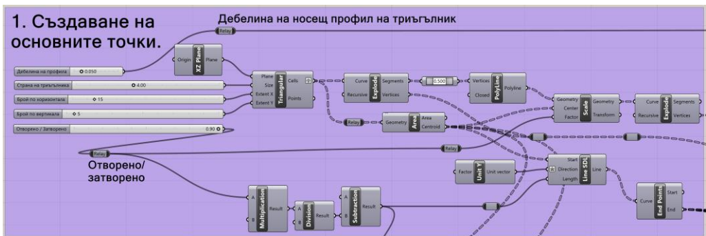
Фиг. 5. Първа стъпка в завършен вид – създаване на основните точки за изграждане на машарабуя.
