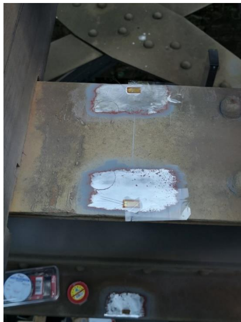
б) залепване на тензометричните датчици
