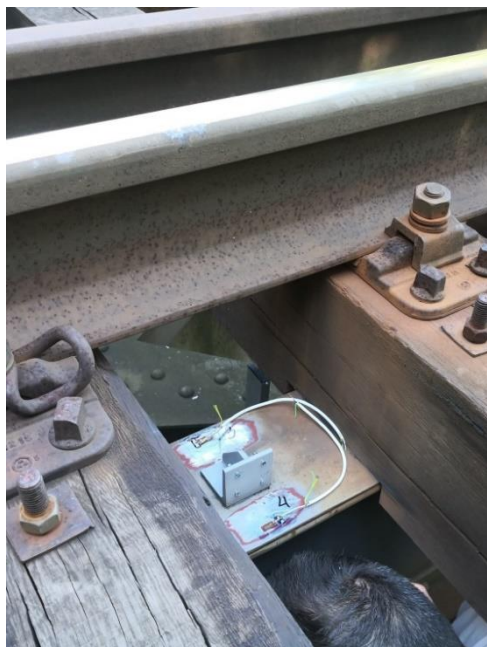
г) залепване на допълнителен ъглов профил за датчиците, мерещи ускорение
