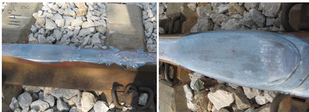
Фиг. 7. Повредени релси вследствие буксуване на товарен влак
