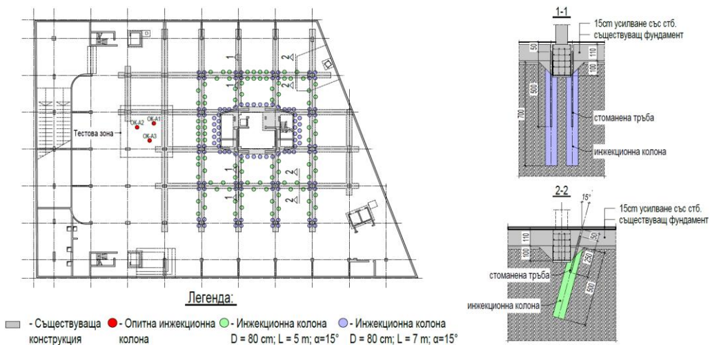
Фиг. 2. План и разреза на приложния метод за усилване
