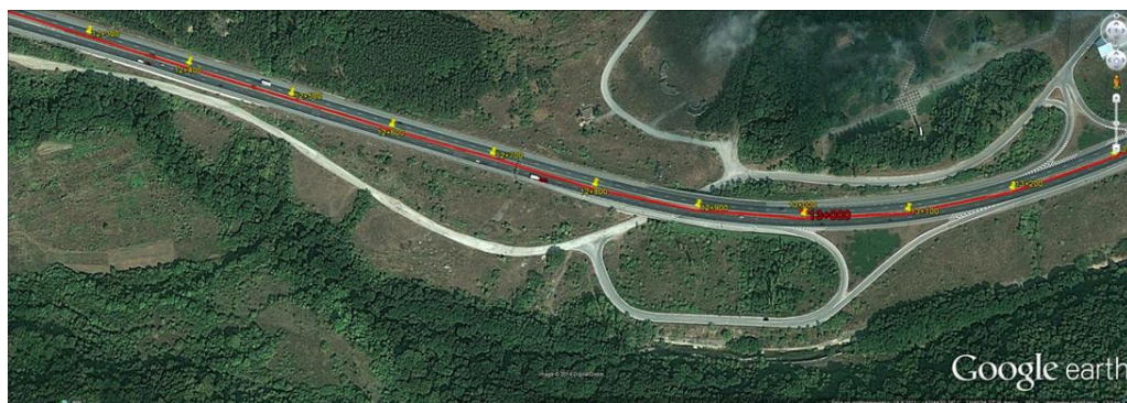
Фиг. 4. Пример за ос, хектометрични и километрични знаци на отсечка от пътя в Google Earth
