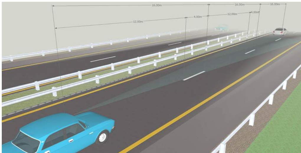
Фиг. 3. Схема на метода за определяне на наличната видимост от гледна точка на водача на МПС
