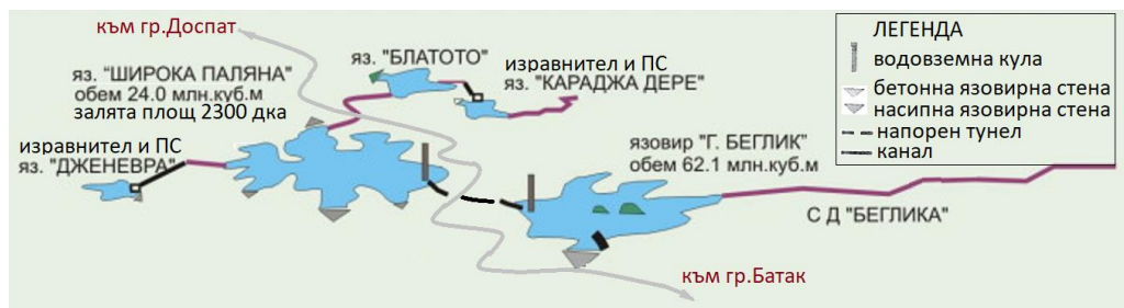
б) Визуална схема на хидровъзел „Широка поляна“
