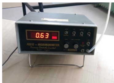
Фиг. 6. Електронен микроманометър MS 351 Фиг. 7. Електронен микроманометър FCO 12
