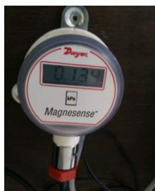
Фиг. 6. Електронен микроманометър MS 351 Фиг. 7. Електронен микроманометър FCO 12
