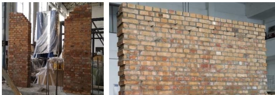
Фиг. 5. Връзка между ограничаващите елементи и зидарията: стена CMFuS и CMWuS с назъбвания, а в стена CMDuS без назъбване
