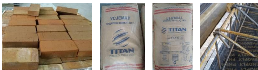
Фиг. 8. Използвани материали – блокове и разтвор за зидария и армировъчна стомана
