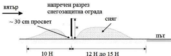
Фиг. 10. Потенциално отлагане на снежни маси при предпазна ограда от преносими инвентарни щитове (Германия) [3]
