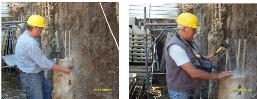
Фиг. 46 и 47. Моменти от проведените ултразвукови изследвания: на скоростта в бетона (ляво) и на интегритета на пилотите (дясно)
