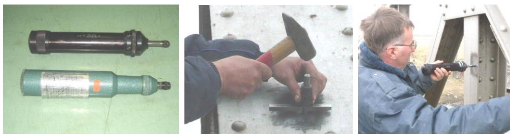
Фиг. 13, 14 и 15. Твърдомери „HPS“ (ляво-горе и дясно), Кремиковец и Полди (средата)
