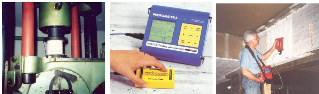
Фиг. 30, 31 и 32. Изпитване на изрязани сондажни ядки (ляво) и диагностики на армировки с Profometer 5 на Proceq (срета) и с Ferroscaan на Hilti Corporation (дясно)
