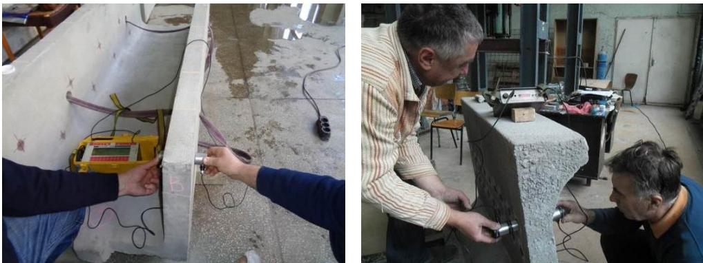
Фиг. 56 и 57. Ултразвуково прозвучаване за окъчествяване на монтажни бетонни канавки ЕКТ 200/50 (ляво) и перонни елементи ПЕМ 76 (дясно)
