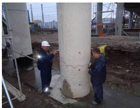
Фиг. 62 и 63. Моменти от проведените ултразвукови изследвания на еднородността и якостно-деформационните характеристики на бетона в ст.б. колони на пътен надлез Стамболийски (2017 г.)
