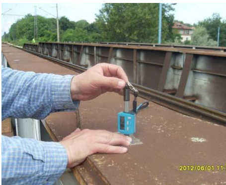
Фиг. 35 и 36. Дистанционна диагностика на лагери на плочест мост (ляво) и БК на стоманен мост в гр. Пловдив с електронен твърдомер за метали EQUOTIP на фирма Proseq (дясно)
