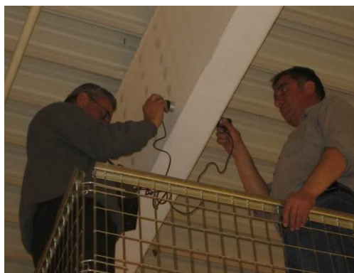
Фиг. 58 и 59. Ултразвуково прозвучаване за окачествяване на набивни ст.б. пилоти (ляво) и на ст.б. столици от сглобяемите покривни конструкции на магазините БИЛЛА (дясно)
