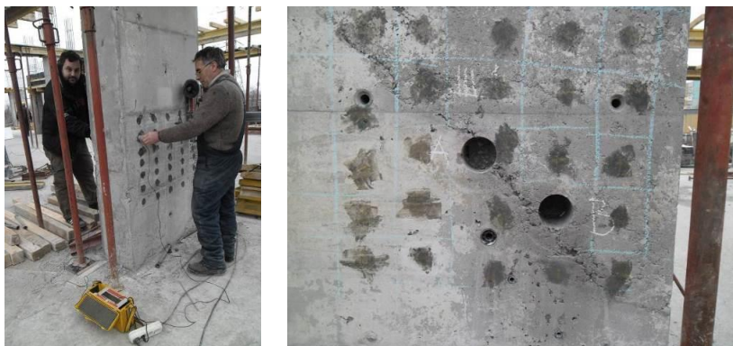
Фиг. 66 и 67. Ултразвукови изследвания за окачествяване на ст.б. стени в новостроящ се цех за захарни изделия в гр. София (2014 г.)
