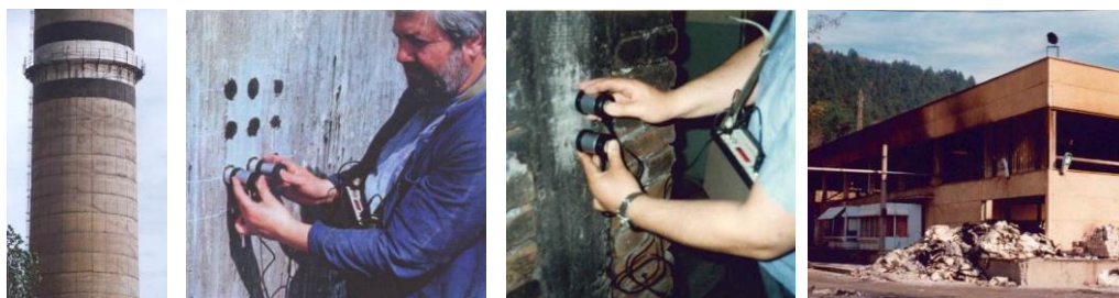
Фиг. 20, 21, 22 и 23. Ултразвуков БК на комина на ТЕЦ „Видахим“ (ляво) през 1996 г., на ст.б. колони и покривни конструкции след възникнали пожари в сграда на ул. Кр. Попов в София (средата) през 1997 г. и в склада за суровини на фирма „Белана“ през 1998 г. (дясно)
