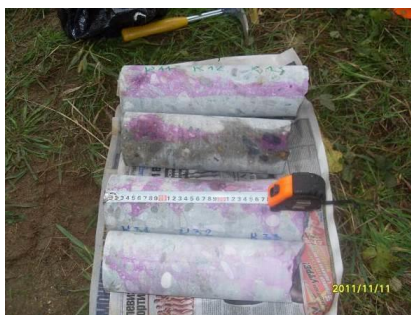
Фиг. 33 и 34. Определяне на дълбочината на неутрализация на бетона по „колориметричен“ метод (ляво) и на потенциала за корозия на армировката с CANIN+ (дясно)
