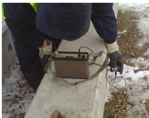
Фиг. 58 и 59. Ултразвуково прозвучаване за окачествяване на набивни ст.б. пилоти (ляво) и на ст.б. столици от сглобяемите покривни конструкции на магазините БИЛЛА (дясно)
