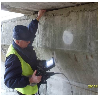
Фиг. 35 и 36. Дистанционна диагностика на лагери на плочест мост (ляво) и БК на стоманен мост в гр. Пловдив с електронен твърдомер за метали EQUOTIP на фирма Proseq (дясно)
