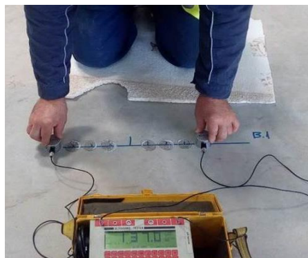
Фиг. 60 и 61. Ултразвукова диагностика на проявени пукнатини в плочите на Мегапарк София (ляво) и в индустриалната безфугова настилка на ЛИДЛ Кабиле (дясно)
