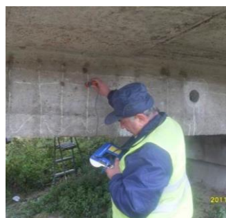
Фиг. 33 и 34. Определяне на дълбочината на неутрализация на бетона по „колориметричен“ метод (ляво) и на потенциала за корозия на армировката с CANIN+ (дясно)
