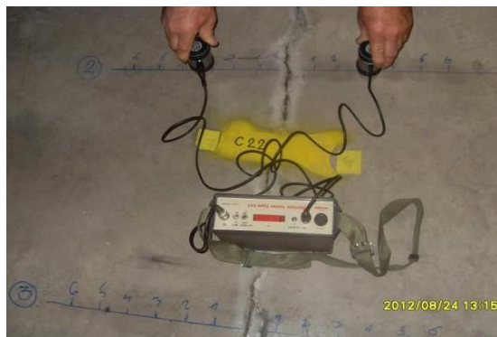
Фиг. 60 и 61. Ултразвукова диагностика на проявени пукнатини в плочите на Мегапарк София (ляво) и в индустриалната безфугова настилка на ЛИДЛ Кабиле (дясно)
