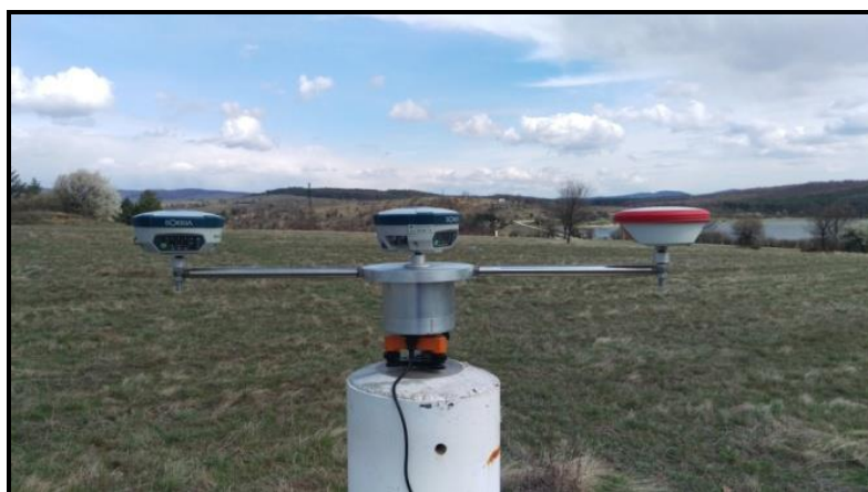
Фиг. 2. Ротираща конструкция, използвана при кинематичните измервания
