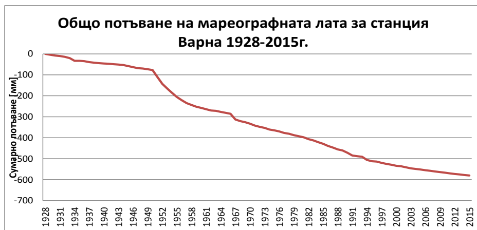
Фиг. 1. Потъване на мареографната лата в мареографна станция Варна за периода 1928 – 2015 година
