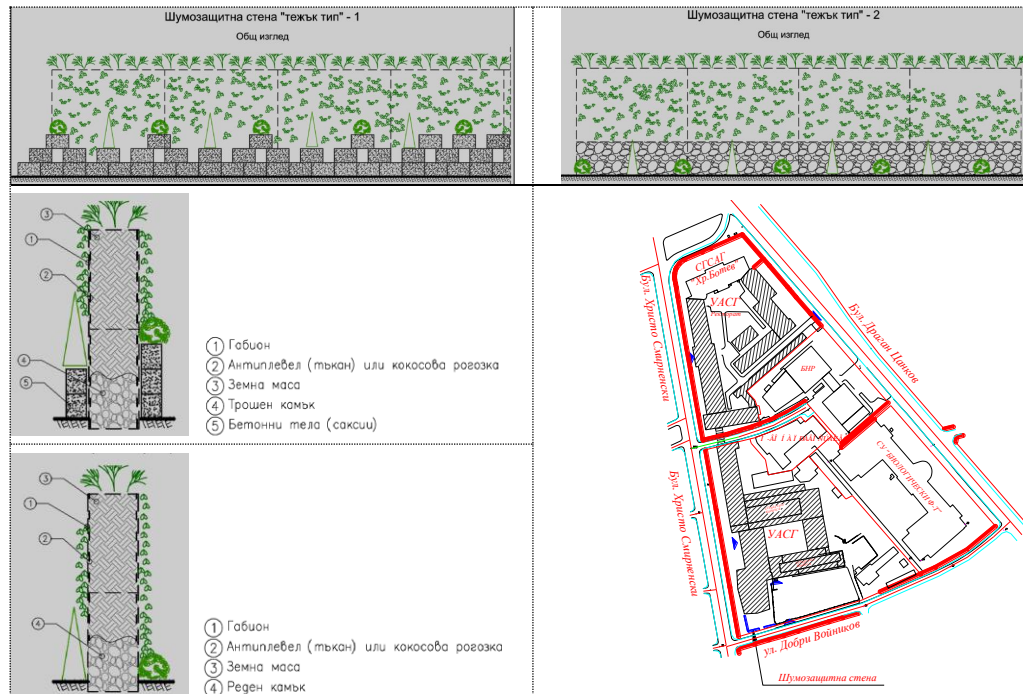
Фиг. 26. Проект на „тежък тип“ шумозащитна стена от габиони [4]
