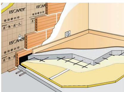
Фиг. 1. „Плаващ под“ със стъклена вата „ISOVER EKOSOL N“ на „ISOVER“ [8]
