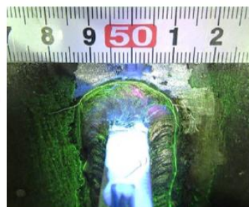
Фиг. 2.9. Уморна пукнатина в ОПП при междинно напречно ребро на пълностенна главна греда [9]
