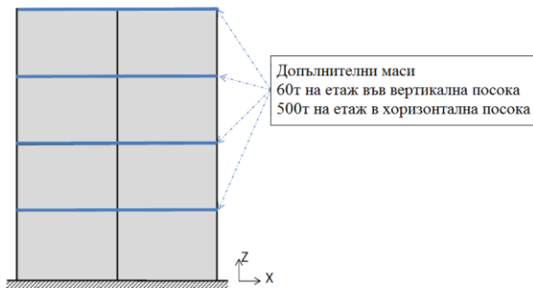
Фиг. 7. Гранични условия и допълнителни динамични маси в конструкцията (зададени от организаторите на проекта)
