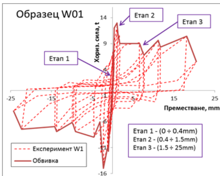
Фиг. 3. Етапи на работа на едропанелни съединения
