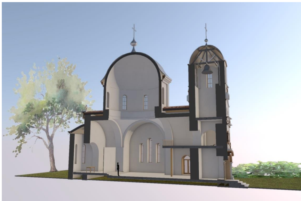
Фиг. 6. Надлъжен разрез на църквата „Св. Възнесение Христово“ в с. Крамолин – дигитален модел – Полина Къосева, Теодора Нинова от АФ на УАСГ
