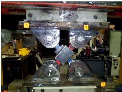
Фиг. 7. „X-link“ XT3 със заварена съставена кутия около отслабената част
