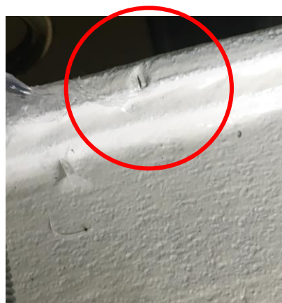
б) тест 01-02, поява на първа пукнатина в цикъл № 24. Отново при наличие на малък механичен подрез
