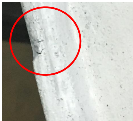
а) тест 01-01, поява на две близки пукнатини в цикъл № 05, провокирани от производствен дефект (механичен подрез)
