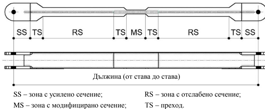
Фиг. 2. Основни зони и типове сечения, съставляващи модифициран диагонал
