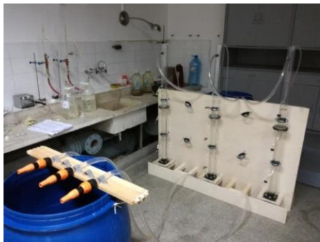
Фиг. 2. Лабораторен модел за изследване на отстраняване на нитрати чрез бавна филтрация:
