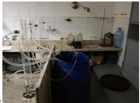
Фиг. 2. Лабораторен модел за изследване на отстраняване на нитрати чрез бавна филтрация:
