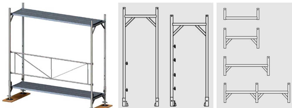
Фиг. 8. Елементи на системи с "П"-образни рамки [17, 18]
