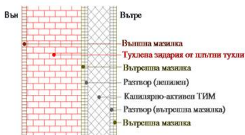
Фиг. 5. Многослойна оградяща конструкция с конструктивна схема тухлена стена
