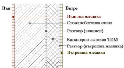
Фиг. 4. Многослойна оградяща конструкция с конструктивна схема стоманобетонна стена
