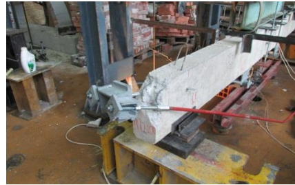
Фиг. 21. Разрушение на зоната при опора вследствие на скъсване на обтегача
