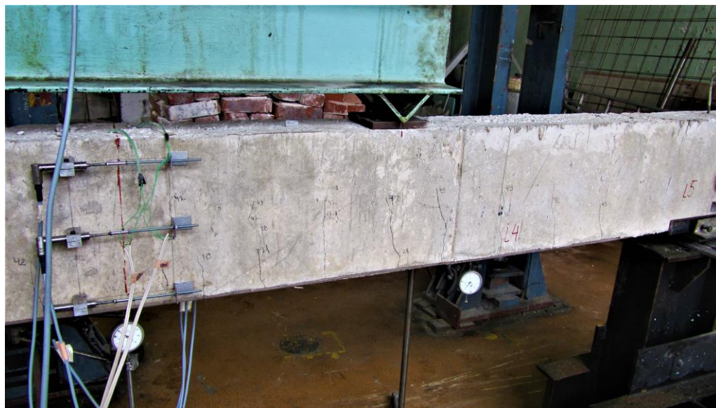
Фиг. 1. Пукнатини в експерименталния образец вследствие на дълготрайна експлоатация
