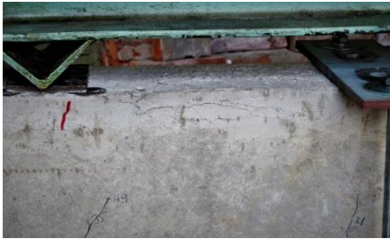
Фиг. 20. Смачкване на натисковата зона
