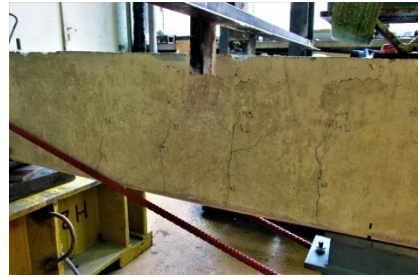
Фиг. 19. Диагонални пукнатини в близост до опорите, причинени от срязване
