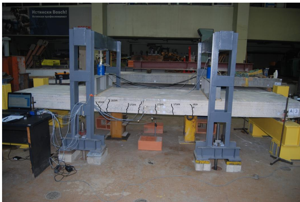
Сн. 8. Деформации и пукнатини при натоварване на Образец 1
