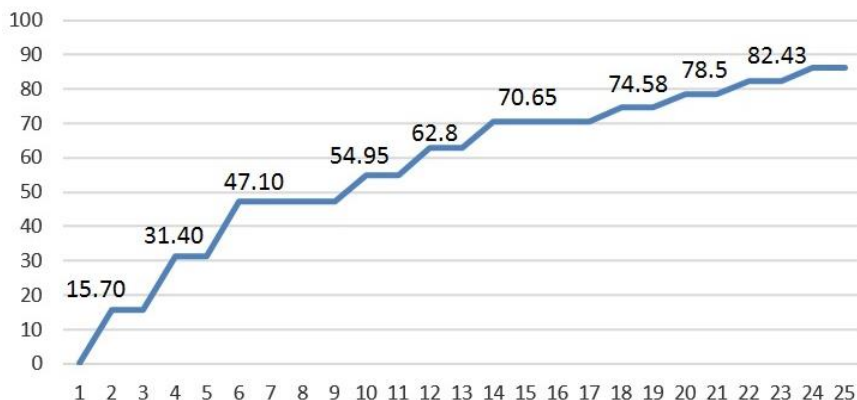
Фиг. 12. Схема на натоварване на етап III до достигане на гранична носимоспособност и разрушаване
