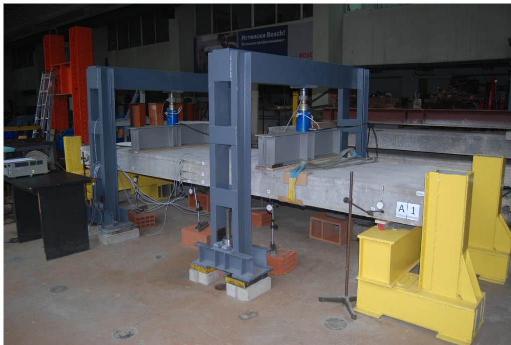
Сн. 1. Позициониран подов панел при стендови и опорни приспособления
