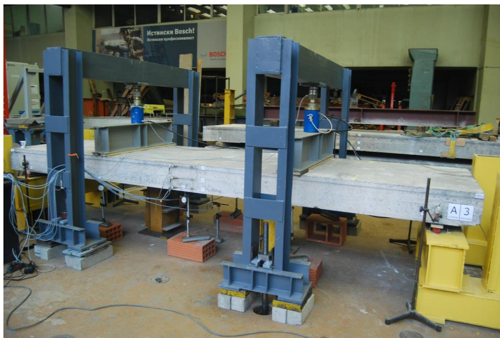
Сн. 5. Деформации и пукнатини при натоварване на Образец 3
