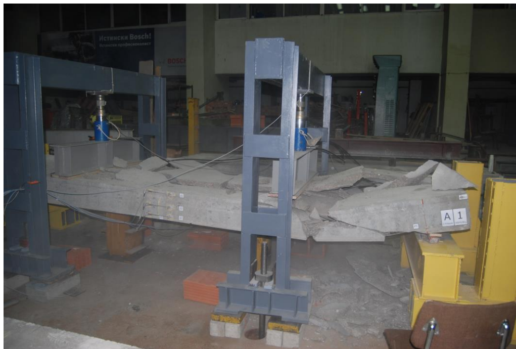
Сн. 9. Разрушение страна А на Образец 1
