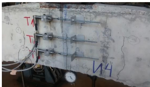
Фиг. 4. Д4 – Пукнатини в средно сечение след натоварване до 100 kN
