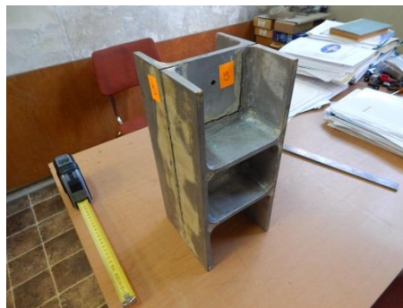
Фиг. 2. Прецизен алуминиев модел за отливка
