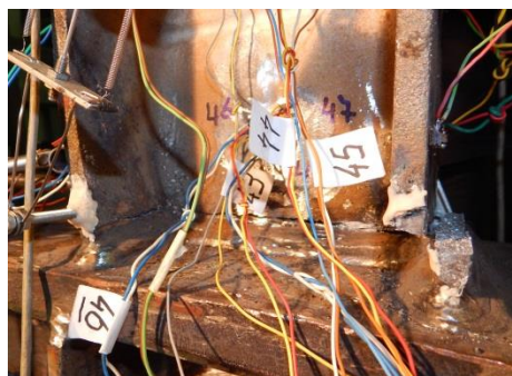
Фиг. 10. Крехко разрушаване на експериментален образец СТ1
