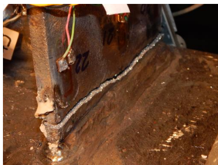
Фиг. 10. Крехко разрушаване на експериментален образец СТ1
