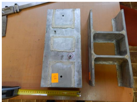
Фиг. 2. Прецизен алуминиев модел за отливка
