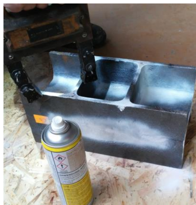
Фиг. 5. Прилагане на магнитно-прахов контрол (ляво), повърхностни микропукнатини в зона с неравномерно изстиване (дясно)
