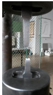
Фиг. 10. Пробни тела за установяване на якостно-механичните характеристики на вложените материали
