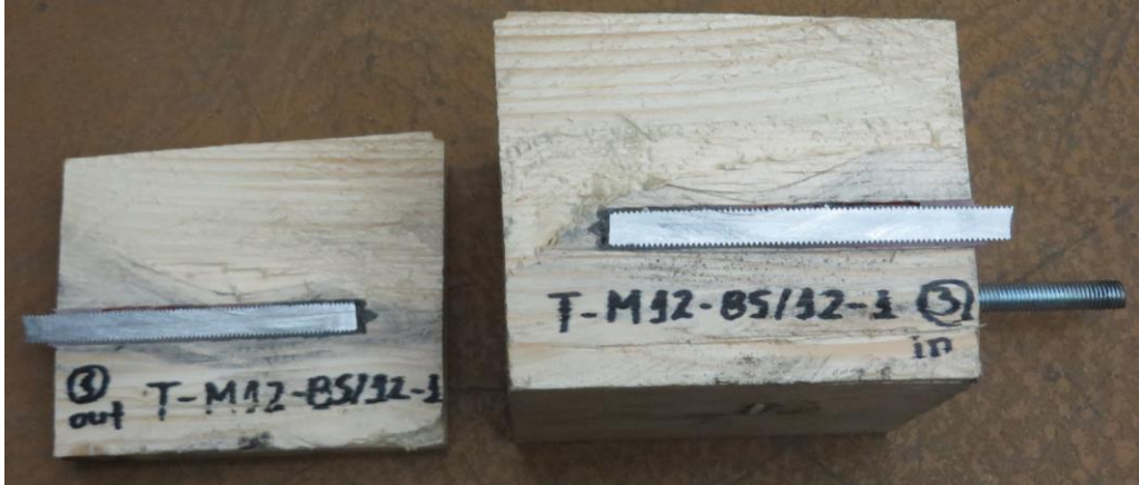
Сн. 5. Разрязан образец T-M12-83/12-1 след разрушение
