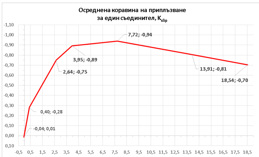
Фиг. 20. Осреднен модул (коравина) на приплъзване K_{slip} по зони
