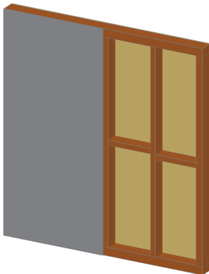
Фиг. 1. Стенен панел – ставна рамка от дървесина, стабилизирана посредством плочи
