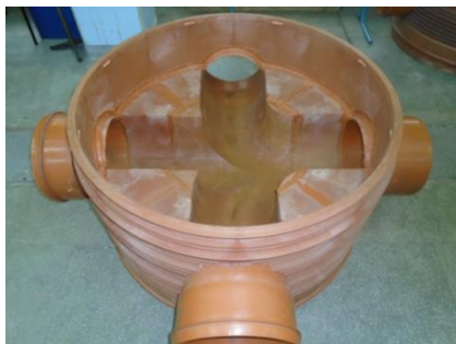
Инжекционно лята ПП РШ DN1000 с три входа и един изход и ъгли: 1-ви вход на 90°, 2-ри вход на 180°, 3-ти вход на 270° и изход на 0° – тип 1
