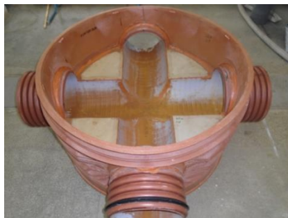
ПП РШ DN1000 с кюнета от тръбни сегменти с три входа и един изход и ъгли: 1-ви вход на 90°, 2-ри вход на 180°, 3-ти вход на 270° и изход на 0° – тип 2
