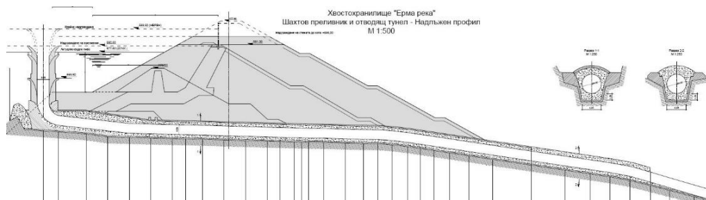
Фиг. 2. Надлъжен профил на преливно съоръжение
