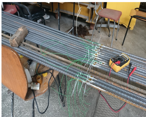
Фиг. 9. Армировъчни пръти със залепените електросъпротивителни деформоприемници
