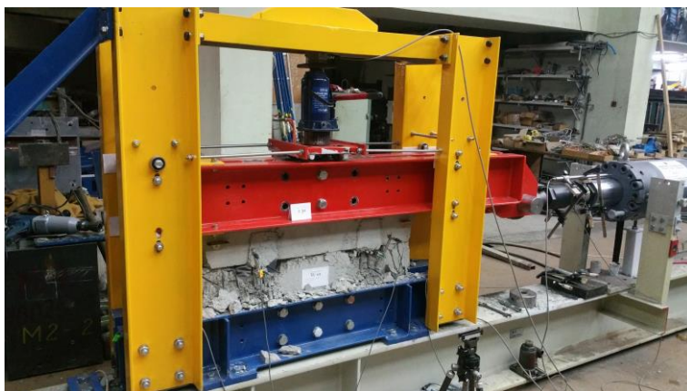
Фиг. 8. Изпитвателна постановка за образец от серия W
