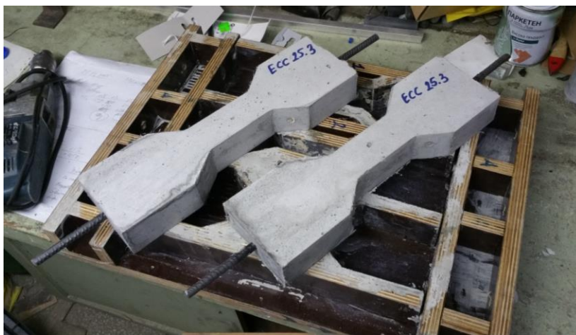
Фиг. 1. Кофражни форми и образци на циментови композити
