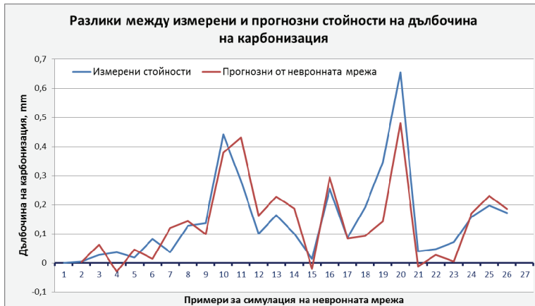
Фиг. 3. Разлики между измерени и прогнозни стойности на дълбочината на карбонизация по примери чрез симулация на обучената мрежа (Share PA = 0, W/C = 0,5, f_{c,28} = 35 MPa, cement = 400, age = 28 days)
