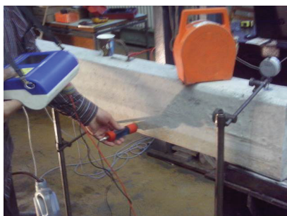
Измерване на потенциала на греда СВ1
