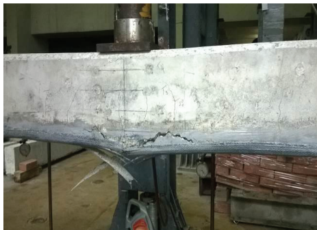
Разрушение на греда СВ1
