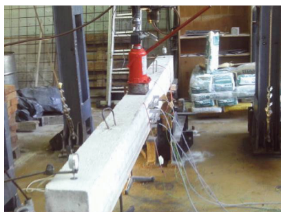
Изпитвателна схема на гредите преди усилване
