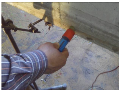
Измерване на потенциала на греда СВ2
