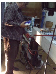
Измерване на потенциала на греда СВ0
