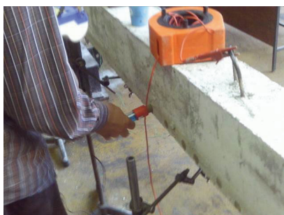
Измерване на потенциала на греда СВ3
