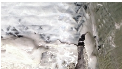
Фиг. 4. Пукнатини в FRP лентата на втори етап
