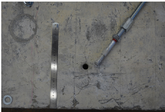
Фотос 7. Сегментен анкер M20-6, бетон клас C16/20
