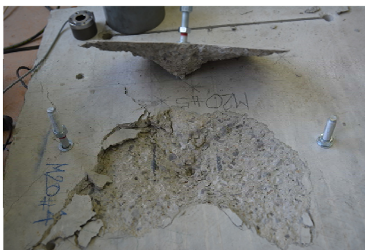
Фотос 8. Химически анкер Ø20-5, бетон клас C30/37
