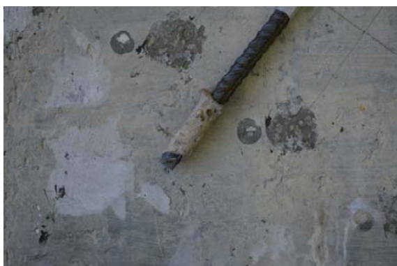
Фотос 5. Химически анкер Ø20-6, бетон клас С16/20
