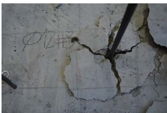
Фотос 6. Химически анкер Ø12-3, бетон клас С30/37
