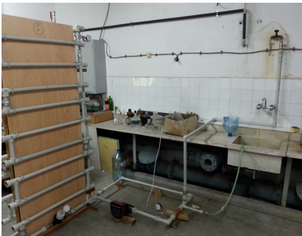
Фиг. 3. Снимка на инсталация за определяне на тегловни загуби на стоманени и чугунени образци
