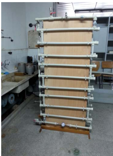
Фиг. 4. Снимка на инсталация за определяне на тегловни загуби на стоманени и чугунени образци
