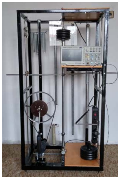
Фиг. 6. Стенд за изследване на вертикални ъглови трептения на тяло с една неподвижна точка – общ изглед
