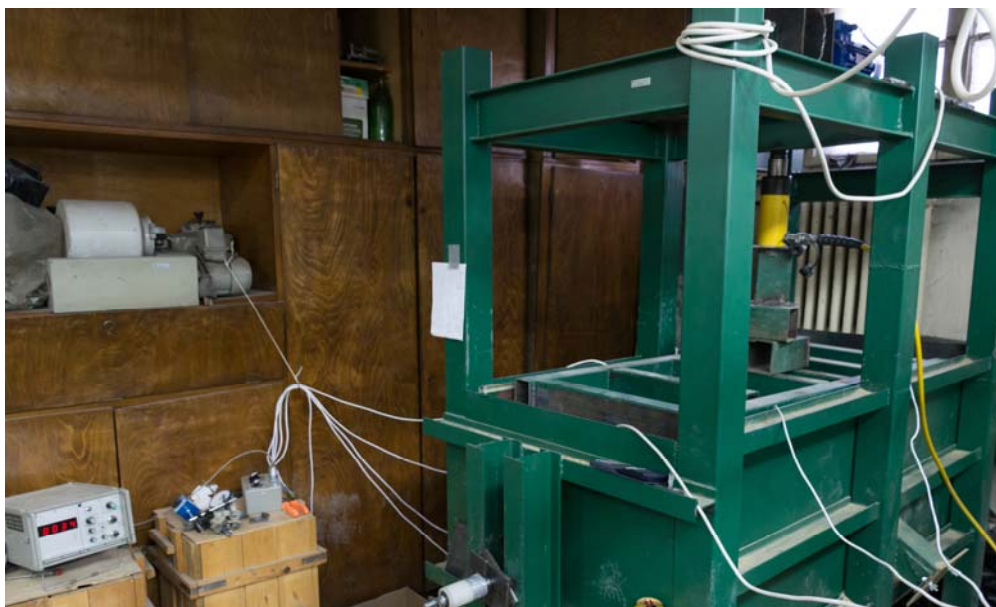
Фиг. 1. Момент от изпитване на анкер
