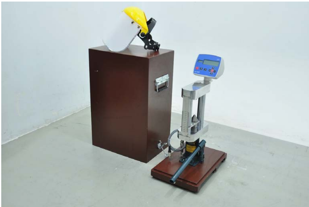
Фиг. 1. Уред за точково натоварване, закупен по проект на УАСГ, София
