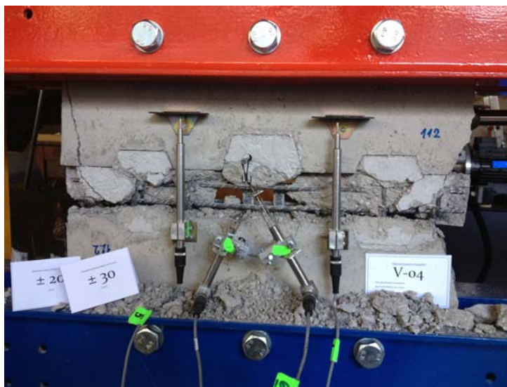
Фиг. 5. Разрушение при образец на вертикално съединение V-04
