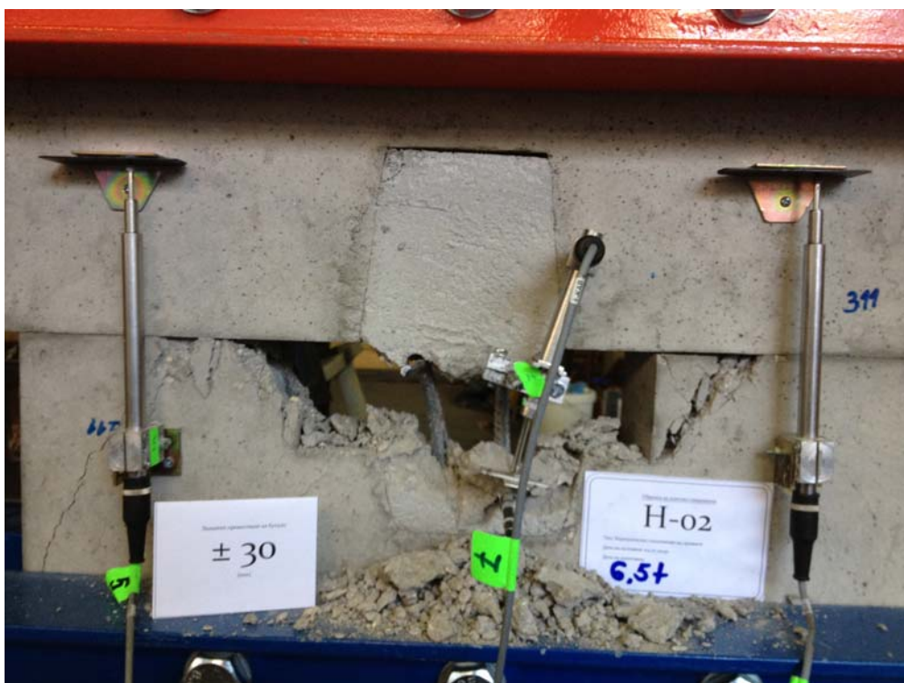
Фиг. 7. Разрушение при образец на хоризонтално съединение Н-02
