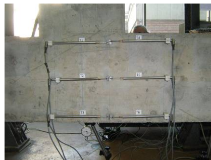
Определяне на относителни деформации посредством индуктивни датчици
