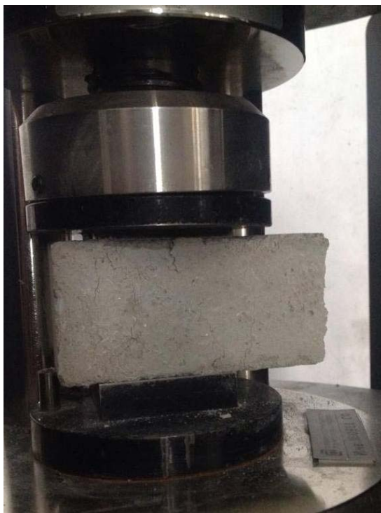
Фиг. 2. Изпитване на пробни тела от ВЦ р-р за якост на натиск
