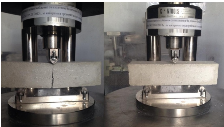
Фиг. 1. Изпитване на пробни тела от ВЦ разтвор за якост на опън при огъване
