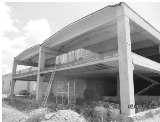
Фиг. 9. Поглед към усиленото поле с изпитвателното натоварване
