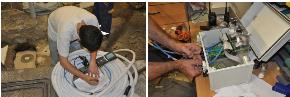
Фиг. 5. Вземане на нулеви отчети и обединяване на сигнала от всички датчици в общ терминал
