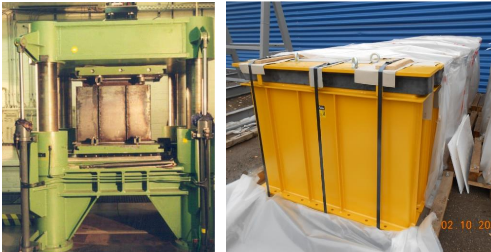
Фиг. 5. Изпитване на виброгасящите устройства и съхраняването им на строителната площадка
